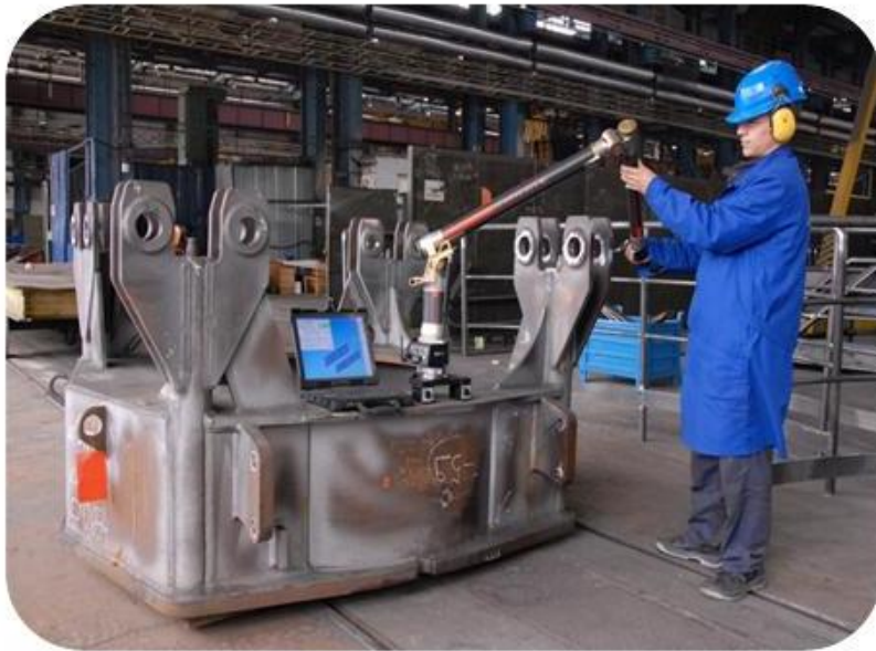
třírozměrný souřadnicový měřicí stroj CimCore 3000 typ INFINITE 2.8 CLOSE X
